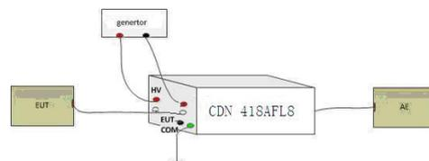
测试连接示意图 2 (线对地测试):
