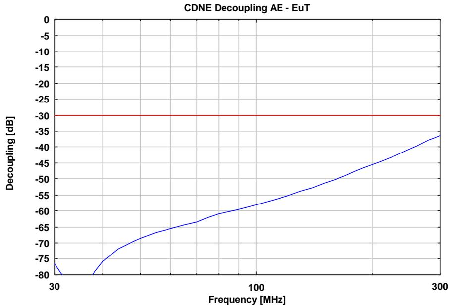
**Abb. 4 Entkopplung AE - EuT**
