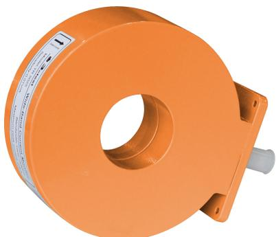
CM 0302M宽带电流监测钳用于5 Hz-2 MHz交变电流及时域脉冲电流的测量。通过电磁耦合方式将时谐信号电流或脉冲信号电流以电压方式传递给记录设备，具有波形无畸变、与电流载体物理隔离等特点。满足各类标准对2 MHz及以下时谐信号、上升时间小于175 ns瞬态脉冲信号的测量需求。广泛应用于电磁兼容传导敏感度（抗扰度）测试。
