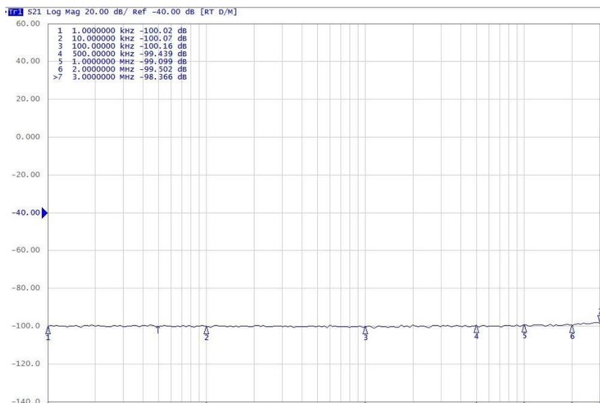
CM 0302M 宽带电流监测钳 s21 曲线\*
