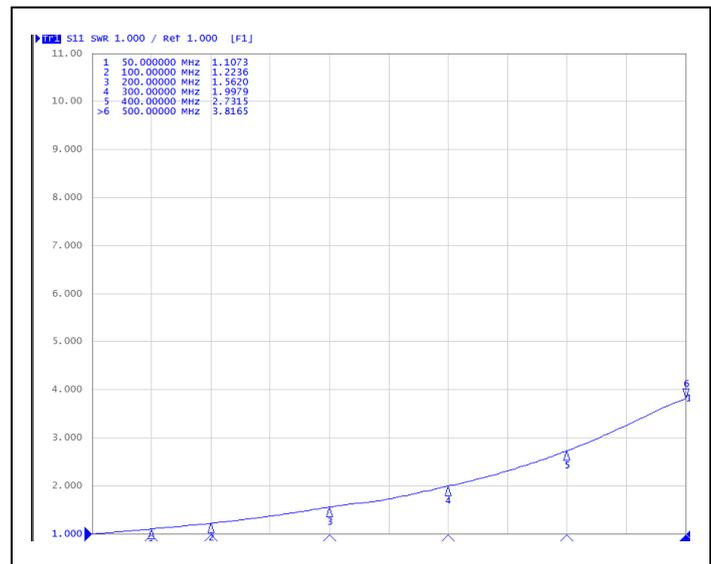
WCMCF 500 宽带电流监测钳校准夹具电压驻波比曲线
